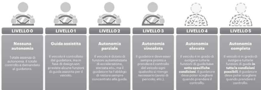
Figura 4.4 Livelli di automazione SAE.
