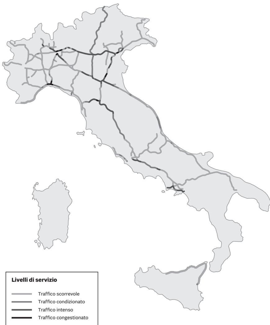
Figura 3.12 Livelli di servizio della rete autostradale a pedaggio nell'ora di punta del giorno medio.
