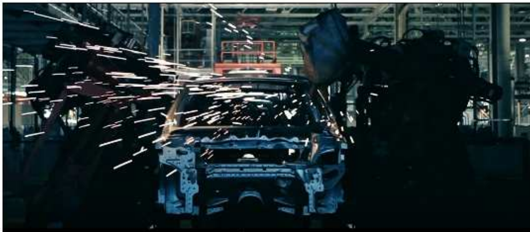
Figura n. 2 – Immagine di saldatura delle lamiere delle auto estratta dal video promozionale “Ecco dove e come nascono le automobili di DR Automobiles” trasmesso da DR Automobiles a partire da dicembre 2021.
